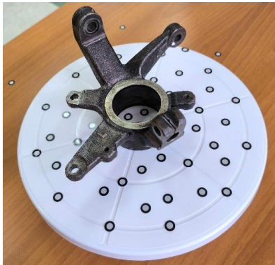
Рисунок 1 – Поворотний кулак квадроцикла Outlander L Max 500 DPS
