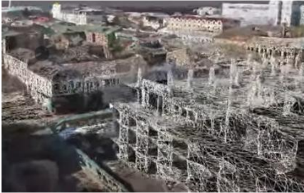
Рисунок 1 – Хмара точок, одержана під час реалізації фотограмметричного сканування забудов центральної частини м. Суми
